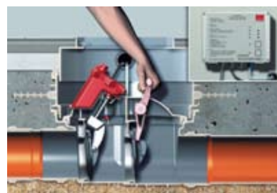
Tvungen blokering: Første klap kan lukkes manuelt.
