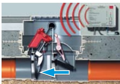
Tilbageløbstilstand: Trykføler aktiverer styreboks og 2. klap lukkes automatisk.
