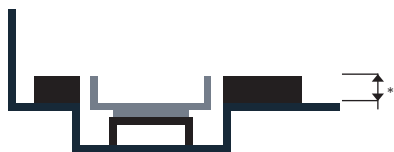
Tværsnit af afløbsarmatur uden ramme/ med Cassette (før montering af materiale).
