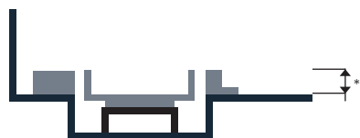
Tværsnit af afløbsarmatur med ramme/ med Cassette (før montering af materiale).
